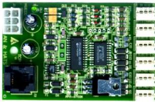
Este elemento se coloca en cada piso. Cada módulo tiene un microprocesador para controlar el funcionamiento
